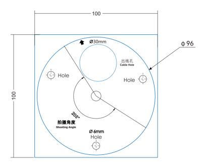
【说明】此设备的水平旋转方向为 $205^\circ$ ,所以在进行安装贴纸时,用户期望监控的方向应与拍摄角度方向一致。
