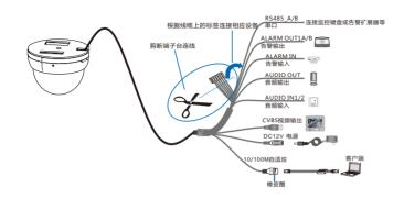
【说明】部分型号支持POE供电,即网口供电,网口连接POE路由后无需连接其他电源。 尾线接口请根据具体型号支持为准,上图所示为接口最全的型号。 线缆识别请参考附录部分。
