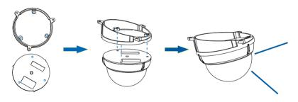
3. 参照前面吸顶安装步骤安装即可完成斜面安装。
