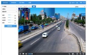
2) 调整设备方向和镜头角度(设备方向:水平205°,垂直70°),直到IPCWeb中的浏览画面达到预定要求。
